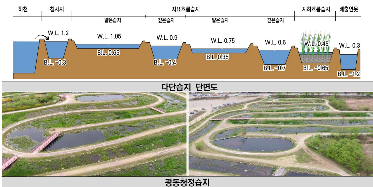
[그림 146] 다단습지 설계모식도 및 사례
